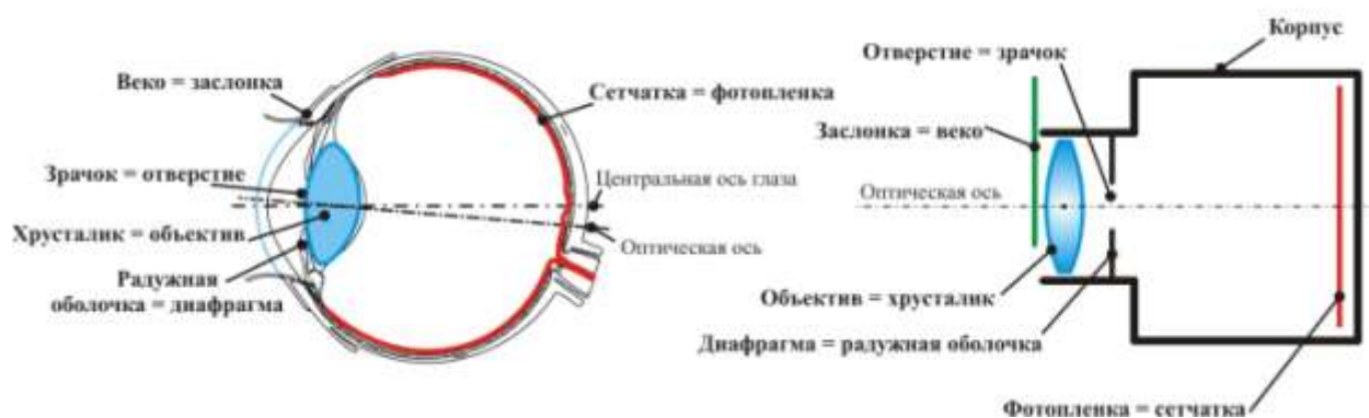
Рисунок Ошибка! Текст указанного стиля в документе отсутствует..28. Схема сравнения фотоаппарата и человеческого глаза
